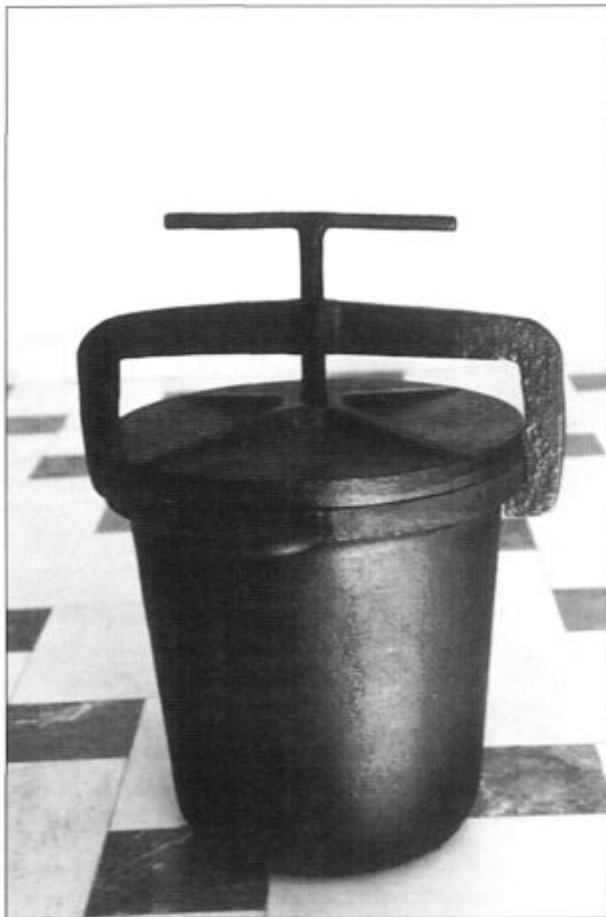
LITOŽELEZNI VRČ ZA PRIPRAVO ČRNEGA SULFIDA PO MOKREM POSTOPKU. (FOTO: M. KURTANJEK)
