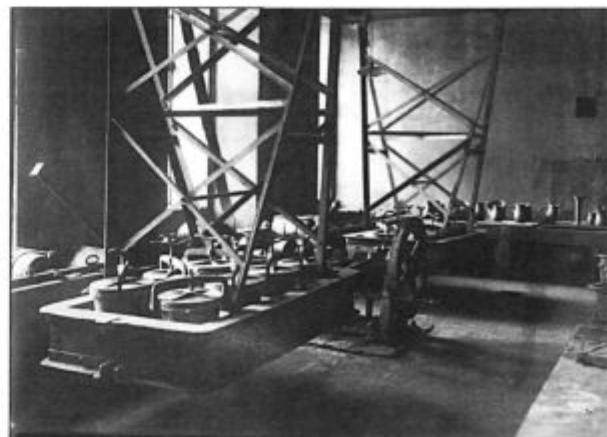
STRESALNA NAPRAVA ZA PRIPRAVO ČRNEGA SULFIDA PO MOKREM POSTOPKU. (IZ ARHIVA MESTNEGA MUZEJA)
