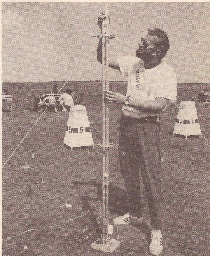
Jože Čuden postavlja svoj štirimeterski model v lanser, ki je konstruiran za izstreljevanje modelov brez vodil.
