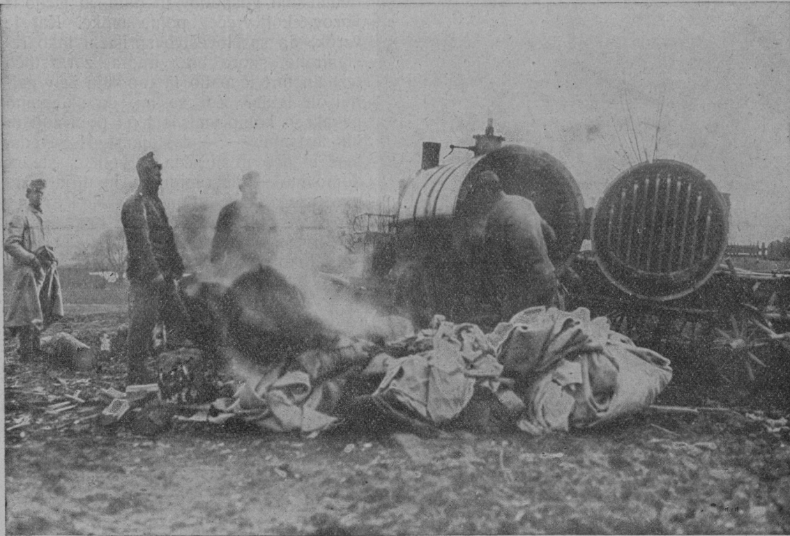
Desinfekčni stroji za uniforme za fronto: Okuženo in mrčesa polno obleko denejo v velike kotle, ki jih potem dobro zaprejo ter napeljejo v nje paro. — Vojak meče iz kotla razkuženo še vročo obleko.
