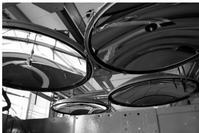
Slika 3: Standardna parabolična zrcala za izredno kakovostno koncentracijo 1 kW sončne svetlobe. S tovrstnimi zrcali dosežejo gostoto sončne moči na površini vzorca več kot 16 \text{ MW/m}^2 . Nekateri starejši sodelavci centra trdijo, da so bila zrcala izdelana v Nemčiji med drugo svetovno vojno, njihova takratna namembnost pa povsem drugačna kot danes. V Font Romeu imajo na zalogi več 10 tovrstnih zrcal, le peščico pa jih dejansko uporabljajo.
