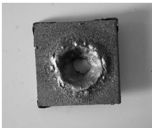
Slika 4: Velika moč koncentrirane svetlobe omogoča taljenje večine materialov, ki niso prozorni za vidno svetlobo. Na fotografiji je vzorec jeklene pločevine dimenzij 20 \text{ mm} \times 20 \text{ mm} \times 1 \text{ mm} po obdelavi z agresivno kisikovo plazmo. Sončna svetloba je bila fokusirana na sredino vzorca.
