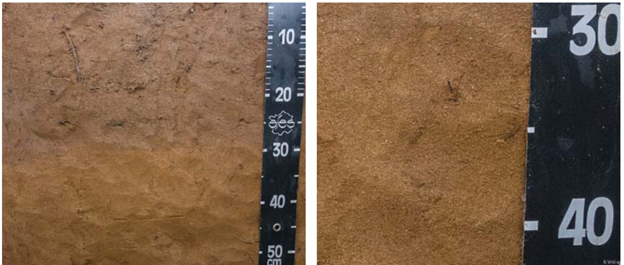
Slika 5: Distrična rjava tla, peščena, globoka, na eolskih nanosih v Prekmurju (levo). Bv horizont(28 cm +) je praktično v celoti droben silikaten pesek (desno) (foto: Borut Vrščaj).
