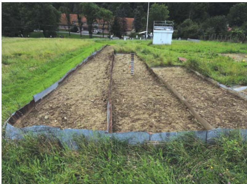
Slika 7: Merilna polja za preučevanje erozije prsti Inštituta za geografijo Poljske akademije znanosti v Szymbarku (foto: Matija Zorn).
