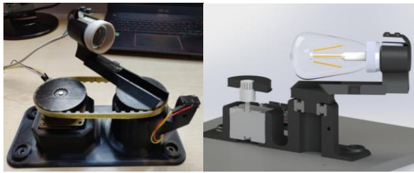
Slika 2: Vrtljiva drsna miza merilnega sistema in 3D model.
