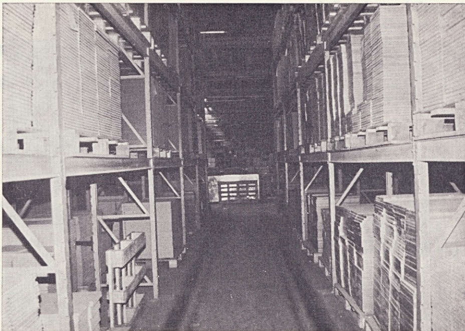
Površinsko obdelani polizdelki v tozdu 2 so pred montažo naloženi na palete in deponirani v velikih, odprtih kovinskih policah. Transport poteka z viličarjem. Skladišče polizdelkov je med oddelkom površinske obdelave in montaže.
