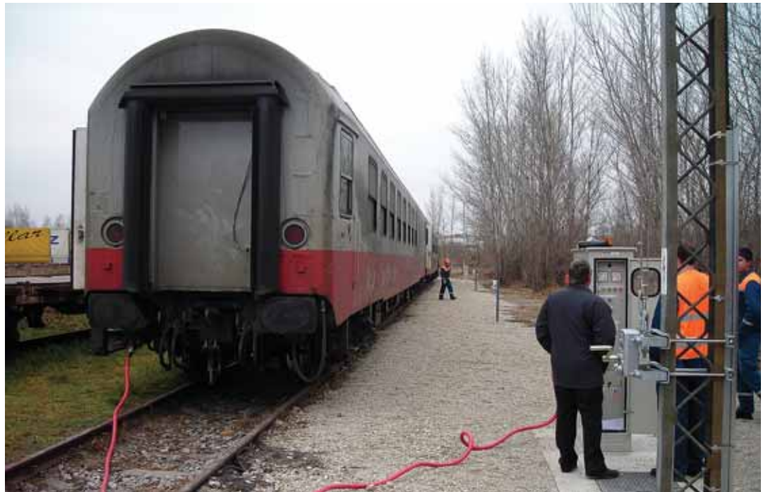
Vagoni oprtnega vlaka na postaji Maribor Tezno se po novem že pred vožnjo ogrejejo s stabilno ogrevalno napravo.
