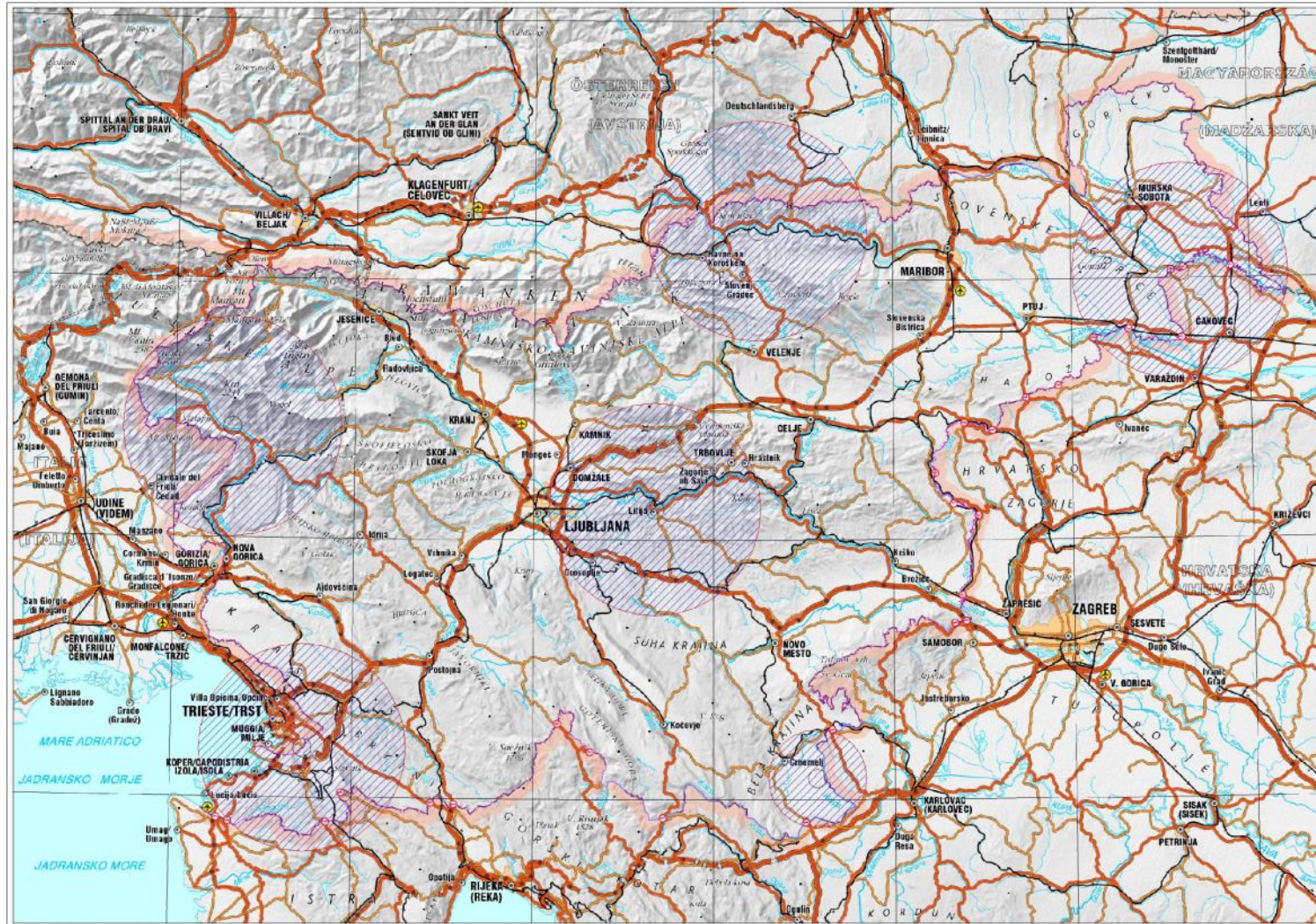
Slika 1.2.1-20: Izbor optimalnih lokacij točk mreže 0. reda, če bi bilo točk šest (kombinacija obeh geometrijskih kriterijev); podloga je državna pregledna karta v merilu 1 : 1.000.000 (ustrezno pomanjšana).
