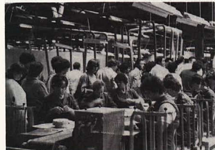
V Cerknem smo obiskali tudi tovarno ETA. Na sliki delavke pri navijanju špiral v plošče za električne štedilnike.
