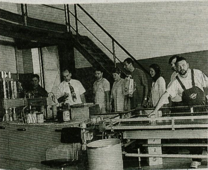
Vodja proizvodnje Jernej Breznik je obiskovalce popeljal skozi prostore polnilnice, kjer imajo dve liniji - eno za tube in drugo za doze od 0,2 do 5 kilogramov. Pri polnilnem stroju za doze sta Jože Kotnik, vodja vzdrževanja, in Lojze Pajek. Pri polni hitrosti in zmogljivosti stroj omogoča visoko količino, tako da lahko v osmih urah s tem, da mu običajno streežesko količino, napolni 4000 doz po 520 ml ali 2000 doz po 930 ml. V ta dva delavca, napolni 4000 doz po 520 ml ali 2000 doz po 930 ml. V osmih urah pa lahko en delavec napolni kar 10.000 tub po 80 ml ali 8.000 tub po 140 ml.
