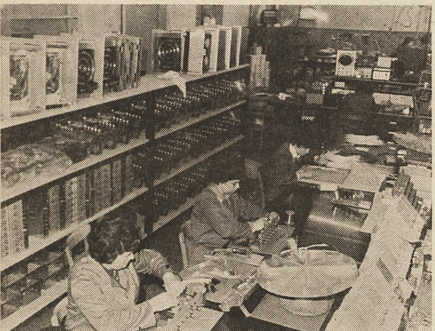
Montažni trak ojačevalnih naprav
