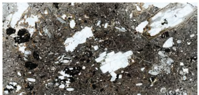
50 Mikroposnetek poliranega zbruska vzorca V–4/13. Presevna svetloba, vzporedni nikoli. Dolžina daljše stranice je 3 cm.
