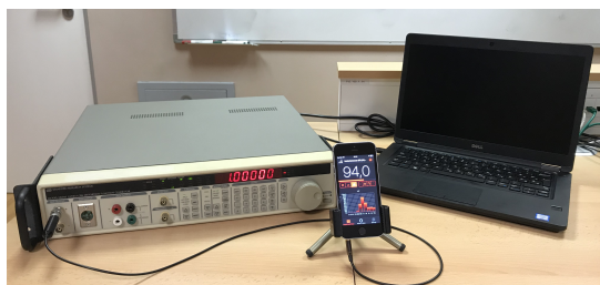
Slika 3: Testna postavitve za testiranje oktavnih filtrov.
