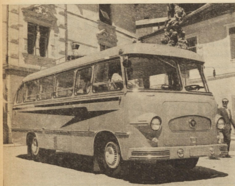
▲ Avtobus „A 3000 T“ - 32 sedežev, zračno hlajen Diesel motor
