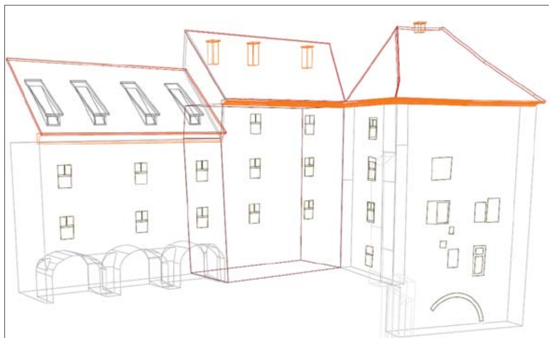
Vmesna stopnja obdelave oblaka točk - 3D CAD linijski model.
