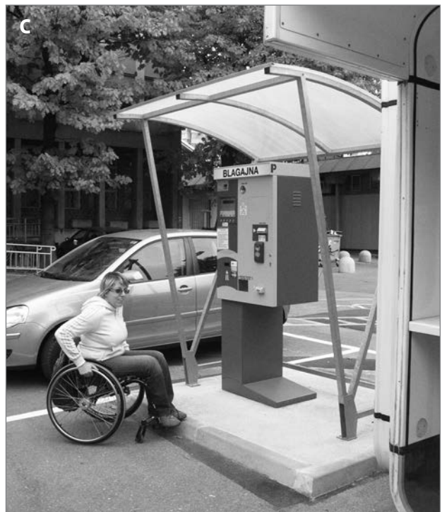
Slika 3: (a) Parkirna mesta za gibalno ovirane, zasedena z vozili, ki do njih niso upravičena; (b) parkirni prostor meji na glavno prometnico in je brez varnega prostora za izstop iz kombija; (c) nedostopen parkirni avtomat.
