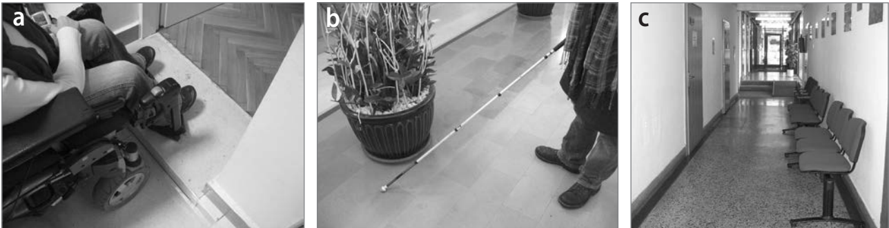
Slika 12: (a) Majhna višinska razlika pomeni nepremostljivo oviro za samostojno gibanje po prostoru; (b) nepričakovana ovira v prostoru zmanjšuje varnost gibanja slabovidnih in slepih oseb; (c) v ozkih hodnikih sicer dobrodošla oprema otežuje gibanje in vstopanje v notranje prostore osebam na invalidskih vozičkih
