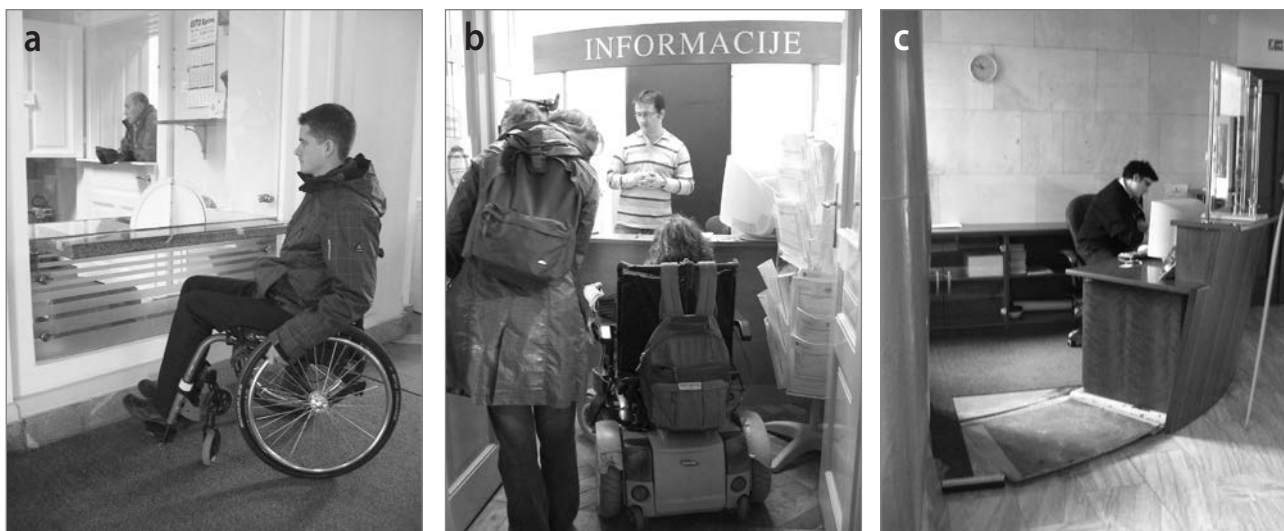
Slika 11: (a) Primer dostopnega informacijskega pulta za osebe na invalidskih vozičkih, ki je hkrati zaradi pomanjkanja kontrastnih oznak neprimeren za slepe in slabovidne, zaradi steklene pregrade pa tudi za gluhe in naglušne osebe; (b) primer zelo nedostopnega informacijskega pulta za osebe na invalidskih vozičkih v objektu starejšega tipa; (c) primer informacijskega pulta, ki je odprt in dostopen z ene strani in zato omogoča primerno komunikacijo za osebe na invalidskem vozičku ter tudi za gluhe, naglušne, slepe in slabovidne osebe.
