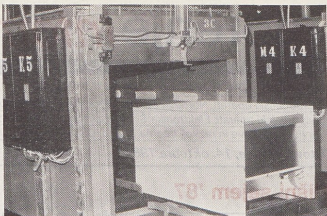
Nagrajena inovacija: Oprema za toplotno izoliranje ohišij hladilno-zamrzovalnih aparatov s poliuretansko peno.
