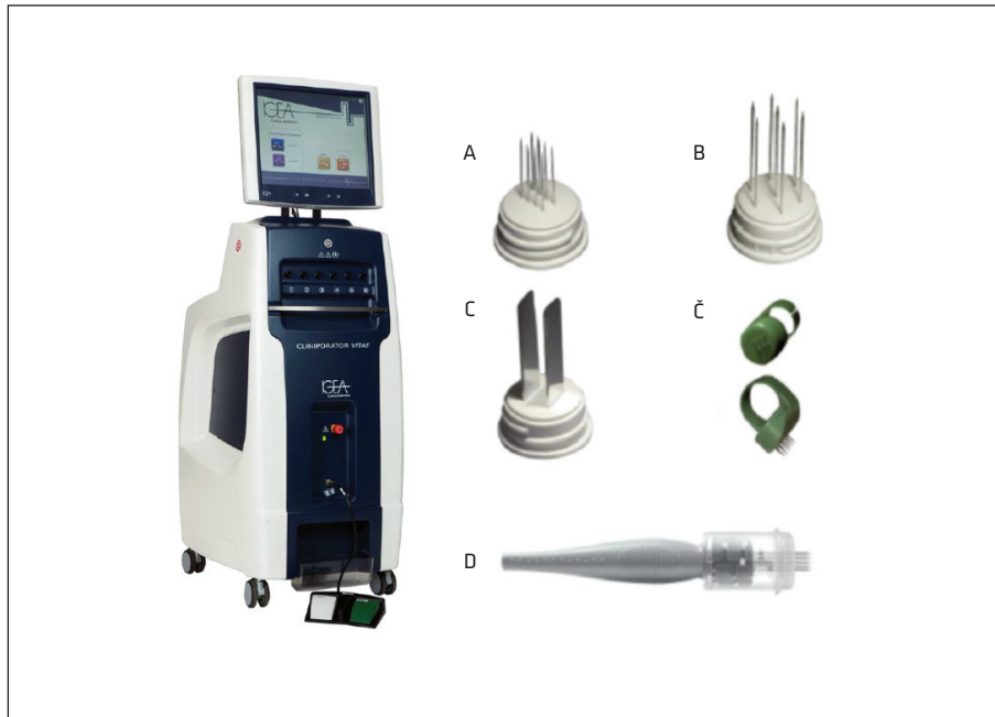
Slika 2. Cliniporator® in elektrode z določeno geometrijo. Izbira elektrode je odvisna od velikosti in mesta tumorja. A – linearno razporejene elektrode za zdravljenje manjših tumorjev v lokalni anesteziji, B – heksagonalno razporejene elektrode za zdravljenje velikih tumorjev v splošni anesteziji, C – ploščate elektrode za zdravljenje eksofitičnih tumorjev, Č – prstne elektrode za zdravljenje sluzničnih tumorjev ustne votline in ustnega žrela, D – elektrode prilagodljive dolžine za zdravljenje tumorjev z različno debelino.
