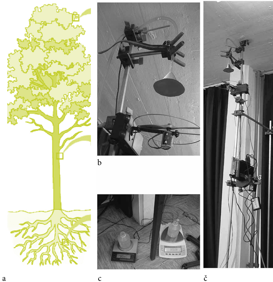
Slika 1: Simbolična predstavitev drevesa in njegovih delov (a) ter umetni analogi: list (b), korenine in zemlja okoli njih (c) in celo umetno drevo (č).
