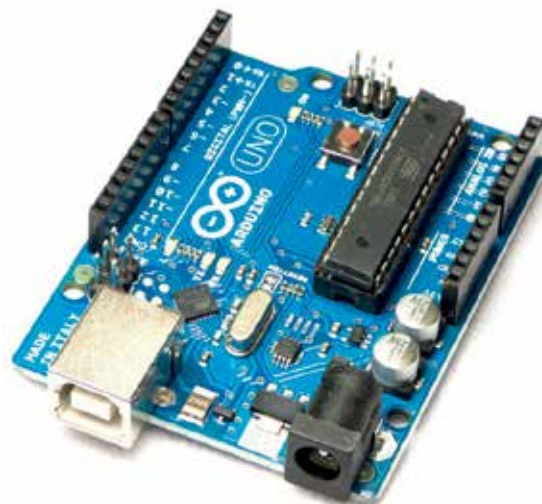
Slika 1: Najpreprostejša razvojna ploščica, Arduino Uno. [4]
