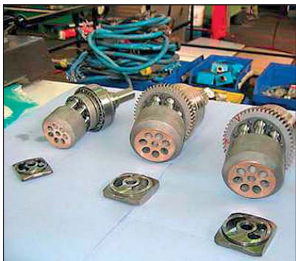
Slika 4. Videz testnih aksialnih batnih črpalk po 1000-urnem testu
