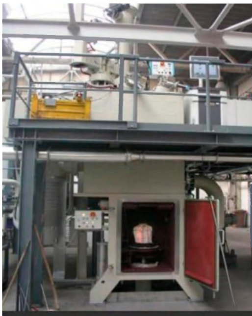
Slika 6. Vakuumska talična peč in priprava za vrtenje ter vibriranje klopi
