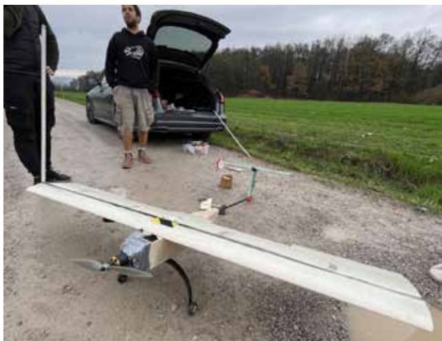
Slika 2 : Prvi prototip za določanje letalnih lastnosti
