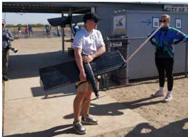
Slika 6 : Konfiguracija za 3. letalno nalogo – 98,5-centimetrska antena, pritrjena na koncu krila
