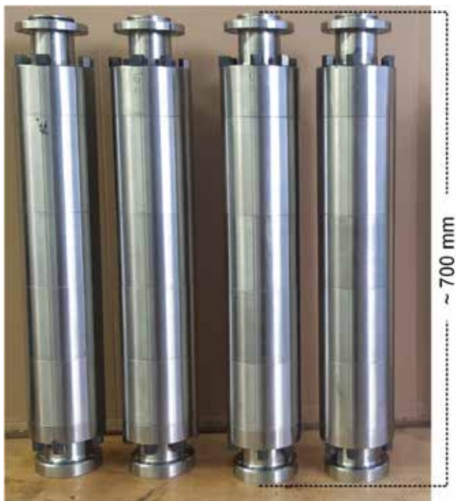
Slika 14 : Izdelani prototipi črpalk za testiranje v vrtinah
