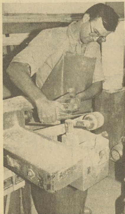
Čiščenje steklenih izdelkov »na suho« se je izkazalo kot neprimerno. (foto Z. Novak)
