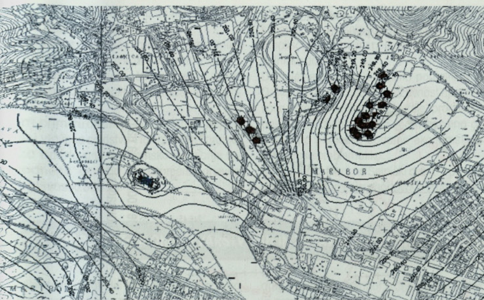
Slika 9 • Hidroizohipse umerjenega modela pri bogatjenju podtalnice s 140 l/s iz dveh vodnjakov na Mariborskem otoku
