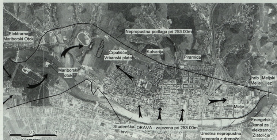
Slika 3 • Inducirana (naravna) obrežna infiltracija Drave v vodonosnik pred umetnim bogatenjem
