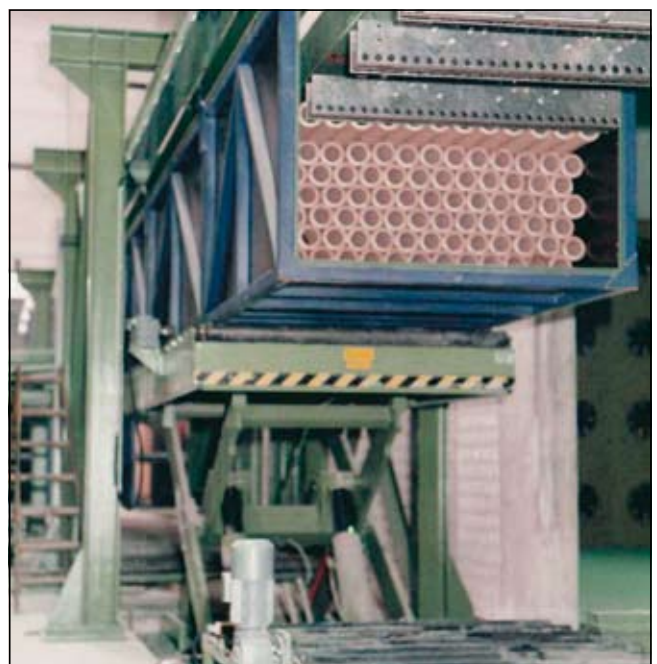
Slika 4. Snemanje cevi po končanem sušenju (pogled C na sliki 1)
