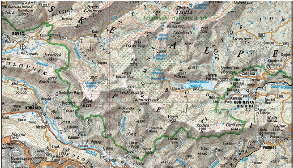
Slika 88: Oblikovanost površja prikazana z višinskimi črtami, kotami in senčenjem na sodobnem zemljevidu srednjega merila (Državna pregledna karta ... 2008).
