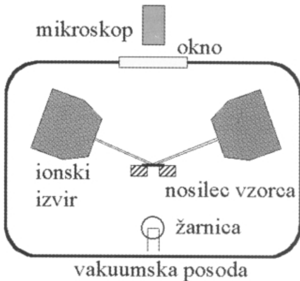
Slika 3: Poenostavljena shema sistema za ionsko jedkanje; prikazana je izvedba z dvema ionskima izviroma
