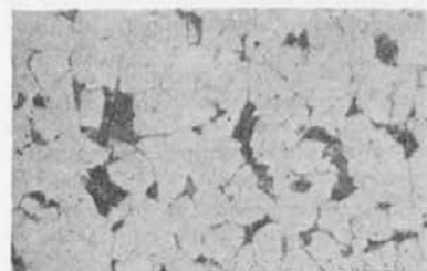
Sl. 1: površina nelegiranega jekla, ki je ohlajano na zraku (normalizirano), polirano in jedkano z raztopino HNO 3 + alkohol. Jeklo vsebuje poleg železa še ogljik (C): 0,15% ogljika (na sliki: 85% feritnih, 15% perlitnih zrn)
