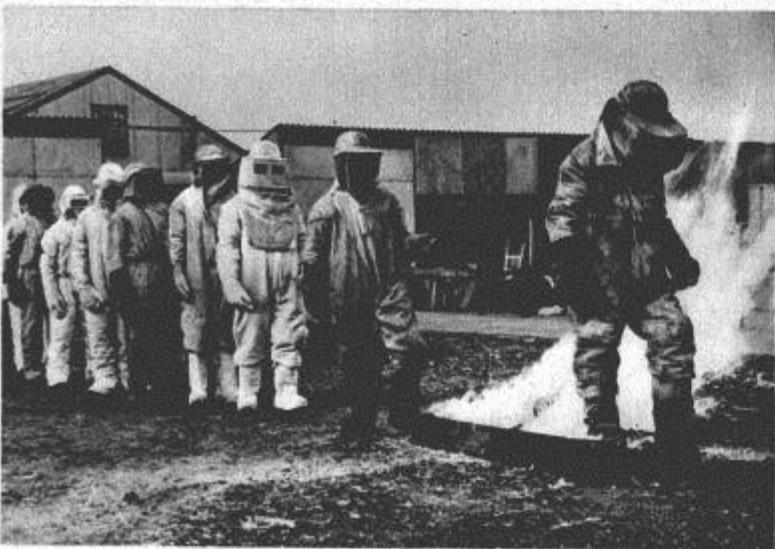
Männer, die durchs Feuer gehen. Bei verschiedenen englischen Feuerwehren sind jetzt neue Abbestanzüge eingeführt worden, die als absolut feuerfester gelten. — Londoner Feuerwehrmänner bei einer praktischen Feuerprobe der neuen Abbestanzüge. Aufn.: B. J. Hoffmann
