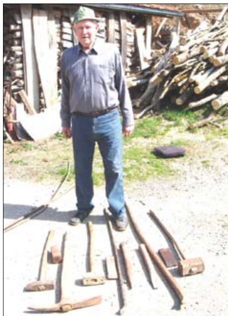
Levo: Apneničar Janez Ivan Križman z orodjem za lomljenje kamna za apnenico ("kajle", lomilna palica ali drog ("štanga"), železni svedri, macole).
