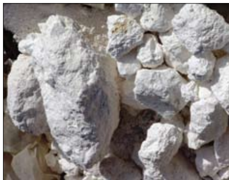
Žgano apno (na sliki) nastane z žganjem apnenca v zidani ali zloženi apnenici pri visoki temperaturi približno 1000 °C. Je veliko svetlejša in lažja od apnenca, iz katerega je nastalo.
