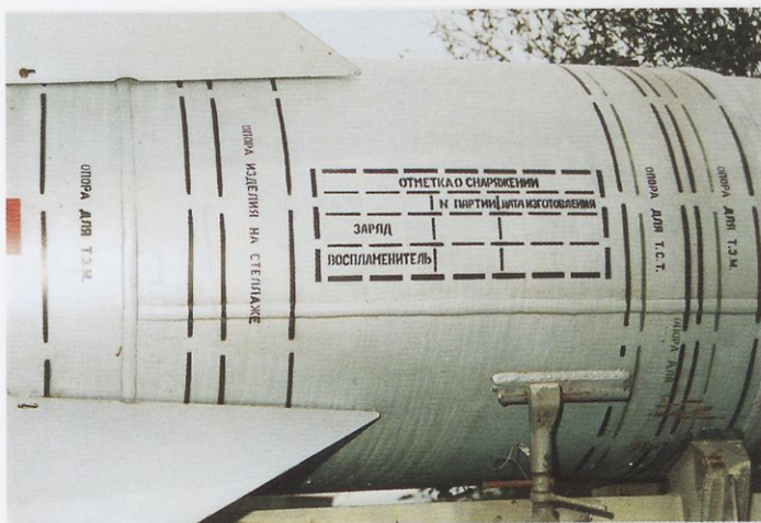
Prva stopnja z desne – zapis o polnjenju: – polnjenje (trdo raketno gorivo), – vžigalnik
