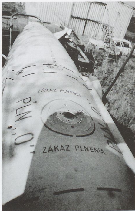
Odprtina za polnjenje oksidanta ( HNO_3 )
