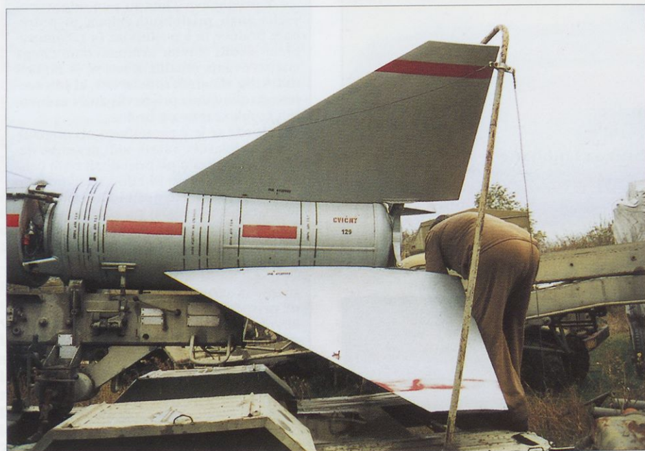
Prva stopnja z raketnim motorjem na trdo gorivo in stabilizatorji
