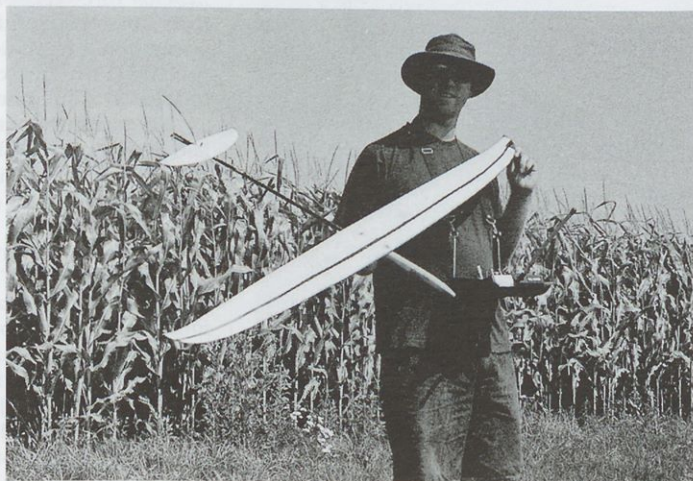
Boštjan Čač z letošnjim tekmovalnim modelom FF. Model ima razpetino kril 1500 mm in tehta okoli 280 g. Krmili višino, smer in zakrilca.
