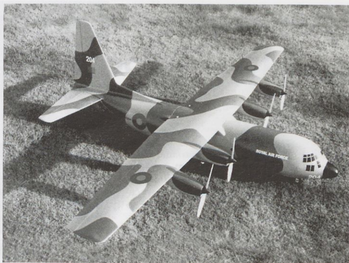
Slika 2. Maketo letala C-130 hercules z razpetino krila 1800 mm in maso 3 kg poganjajo 4 kombinirano vezani motorji speed 400 z reduktorjem 1,85 : 1, ki se napajajo iz 16 celic kapacitete 2400 mAh.
