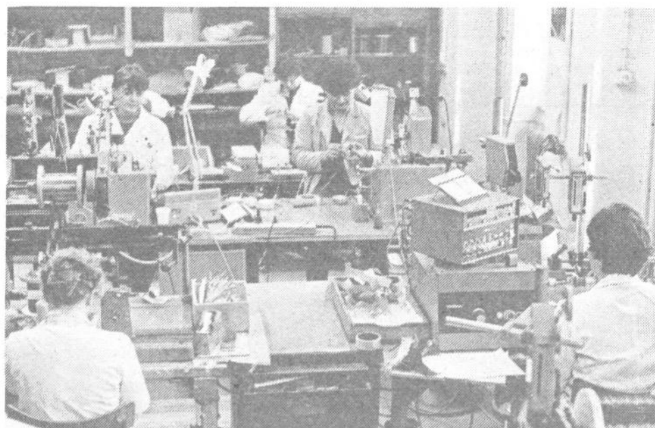
Oddelek proizvodnje elektromehanskih elementov – delavke TOZD SEM hitijo kar se da. Na oddelku navijajo sodobne transformatorje, pri čemer je treba biti na moč spreten.
