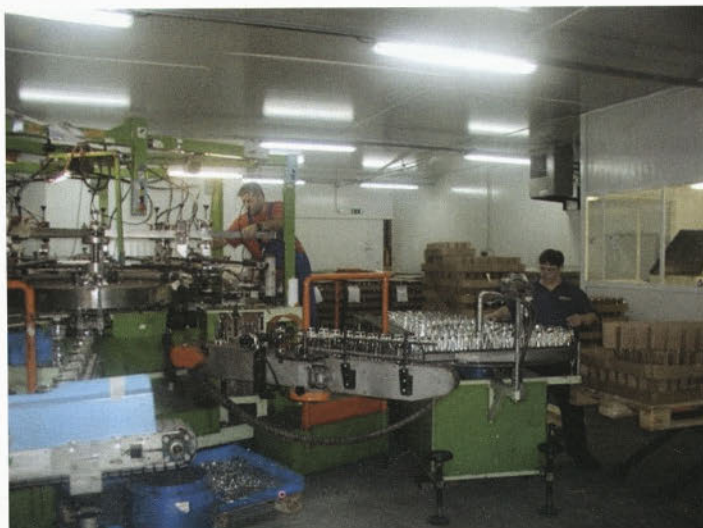
Šestbarvni stroj Fermac, lociran v drugem nadstropju. Na njemu se tiskajo eno ali večbarvni dekorji na razne kozarce, svečnike, pepelnike, v zadnjem času tudi na steklenice, vendar smo pri njih zaradi stroja tehnološko omejeni.
