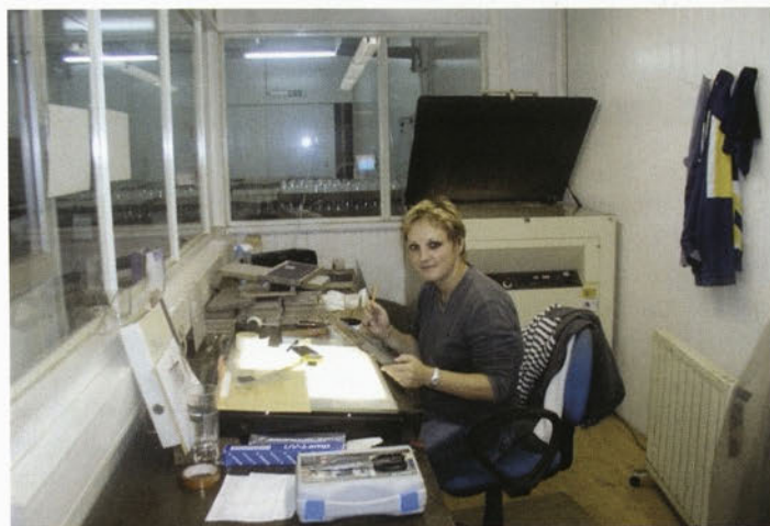
Prostor, imenovan temnica, kjer grafik pripravlja sita za tiskanje na sitotiskarskem stroju. Glede na to, da sta v temnici korito in topla voda, se občasno prostor uporablja tudi za umivanje izdelkov, ki kvalitetno niso sprejemljivi.
