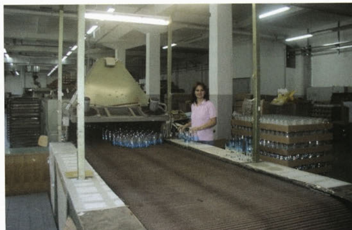
Žgalna peč, kjer se žgejo in pregledujejo izdelki ročnega in strojnega brizganja.
