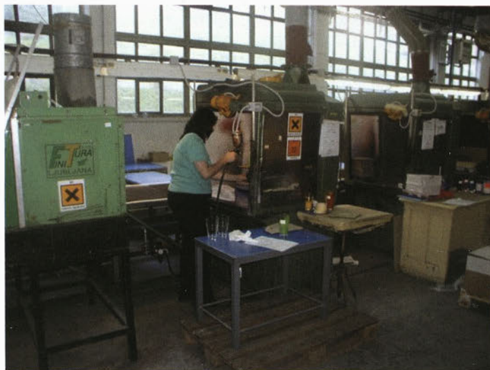
Kabine, namenjene ročnemu brizganju. Tu se brizgajo izdelki večjih dimenzij in zahtevnejših oblik, ki jih ne moremo brizgati strojno. Ravno tako se tu brizgajo razni vzorci.
