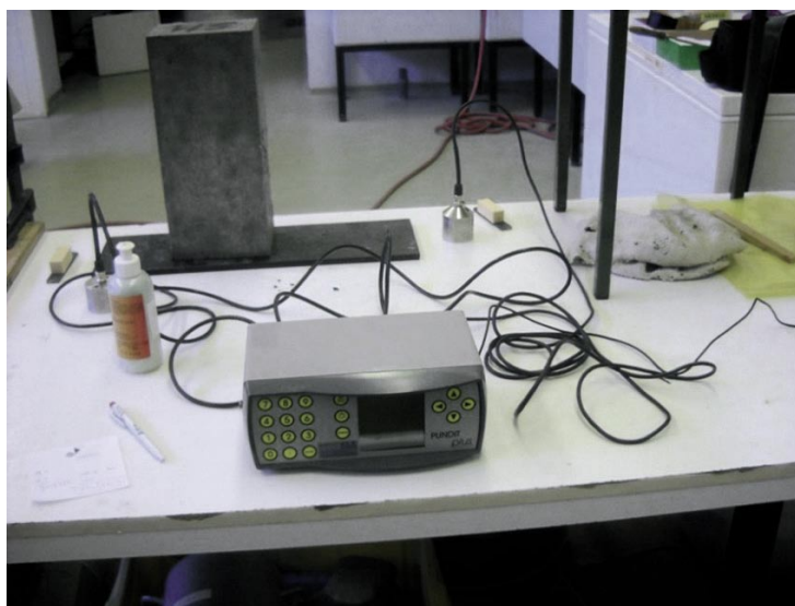
Slika 2 • Meritev časa prehoda ultrazvoka z napravo PUNDIT plus (model PC1006)
