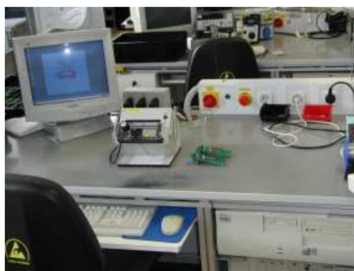
Slika 17: Naprava za funkcijsko kontrolo tiskanih vezij
