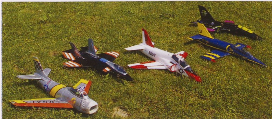
Penasti modeli, ki jih poganja 50-mm impeler tudi na tleh delujejo privlačno.
