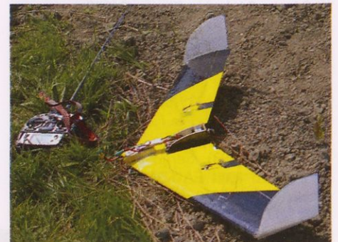
RV-model letečega krila, izdelanega v samogradnji. Penasto jedro je prekrito z barvnimi lepilnimi trakci, pogon pa je nameščen na zgornji strani modela.
