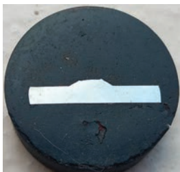
Fig. 2. Macrograph of actual bead formation
