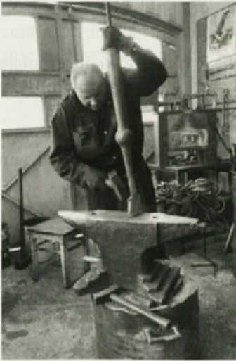
Kovanje kembeljev, umotnostni kovač Robi Struna
