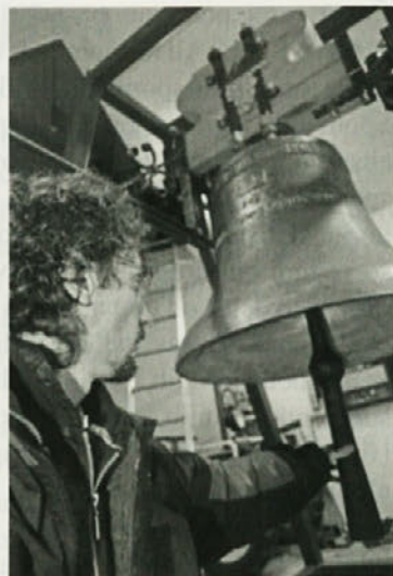
Oprema in test velikega zvona c2, 238 kg ulit leta 2012
