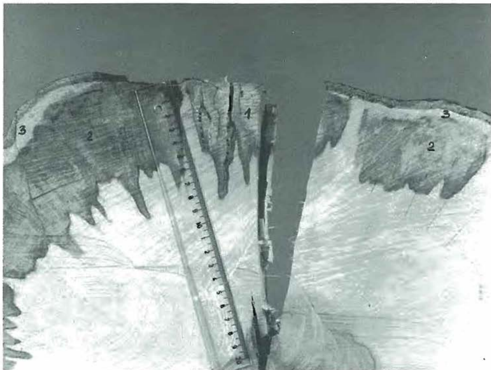
Slika 2: Na prečnem prerezu debla je mogoče razločiti več razvojnih stadijev poškodbe.
