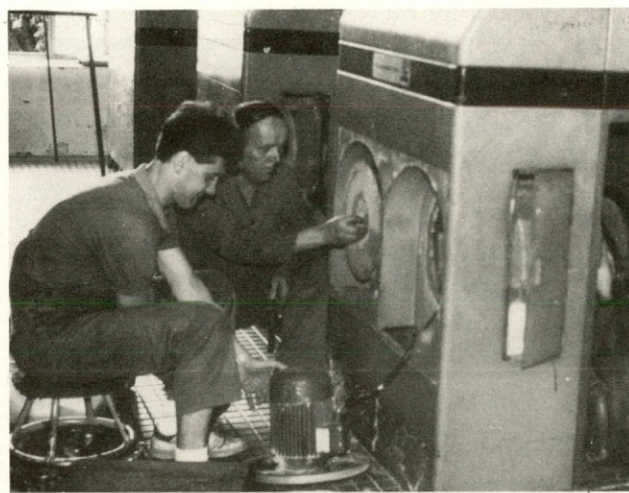
V predilnici so bili potrebni tudi električarji. MARKA LONČARJA in MIHO KRALJA sem slikala pri čiščenju in menjavi ležajev na ventilatorjih v predilnih strojih Carniti.
