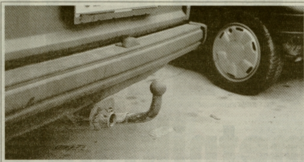
Takšne štrleče vlečne kljuge bo treba zamenjati z novimi, kot jih predpisuje zakon.
