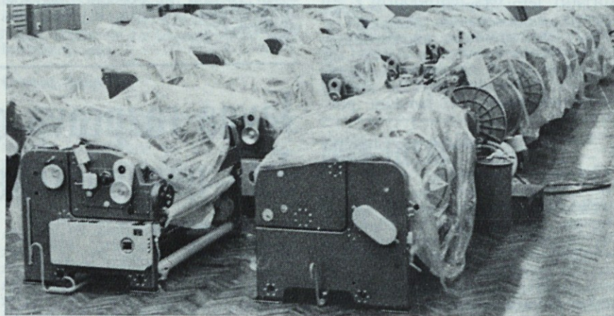
Novi pnevmatski tkalski stroji, katerih šum se bo kmalu zasilal, ki pa bo veliko manjši o sedanjega ropota.
