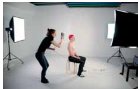
Slika 1: Zajem testne osebe z ročnim skenerjem Sense.
