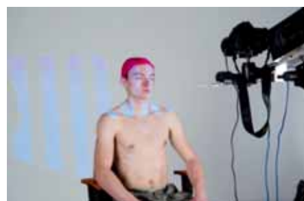
Slika 2: Zajem testne osebe s sprednje strani s skenerjem LabodScan.
