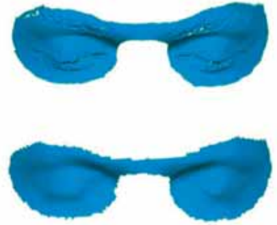
Slika 3: Obarvana mreža na področju oči, pridobljena s skenerjema LabodScan (zgoraj) in Sense (spodaj).
