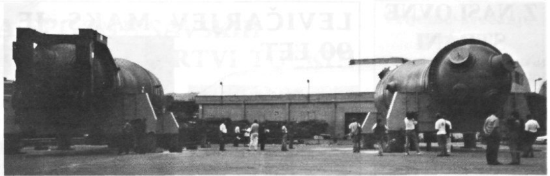
OD KOPRA DO KRŠKEGA prevoz uparjalnikov za jedrsko elektrarno v Krškem, september 1999
