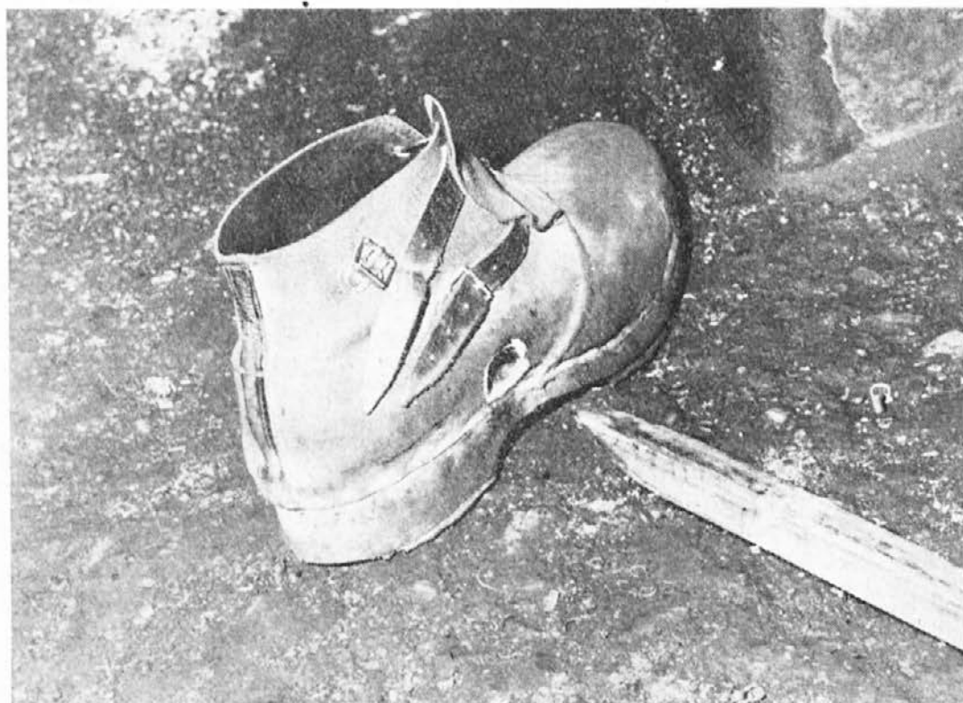
Zareča kača je našla pot skozi vse prepreke od valjarskega ogrodja lahke proge do 30 m oddaljene krožne žage v adjustaži ter prebodla delavca Jožeta Drozga skozi desno nogo pod gležnjem
