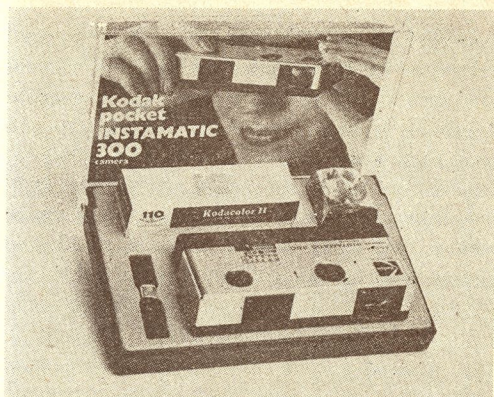
Slika 2 — Najnovejša žepna instamatic kamera, ki uporablja 16 mm širok barvni ali črnbeli film. Velikost slike je 13 \times 17 mm in dovoljuje povečave do 13 \times 17 cm. Z njo lahko snemamo tudi diapozitive (okvirčki merijo 30 \times 30 mm), ki jih projiciramo s posebnim projektorjem iz iste družine.
