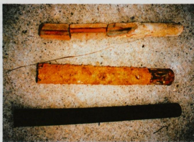
Vodovodi skozi čas. Slika kaže troje vodovodnih cevi iz višnjegorskega vodovoda. Leva je lončena in izvira iz rimskih časov, srednja je litoželezna - narejena verjetno na Dvoru pred dvema stoletjema, tretja pa je iz umetne mase, ki je značilen material današnjih dni.
