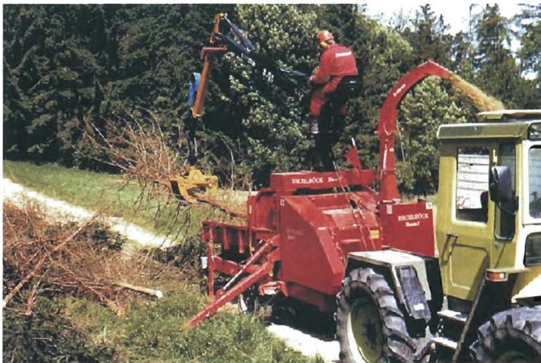
Sekalnik srednjega razreda Biber 7 kot prikolico s traktorskim pogonom in nakladalno napravo (proizvajalec Eschlböck, Avstrija)
